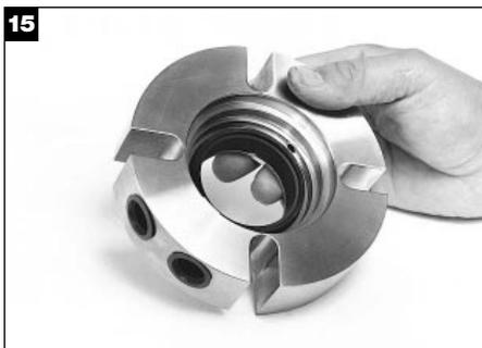
Coloque la parte interna de la brida hacia arriba sobre una superficie plana. Deslice la estacionaria externa dentro de la brida hasta que las lengüetas antirrotativas del empujador enganchen en las ranuras de la estacionaria.
