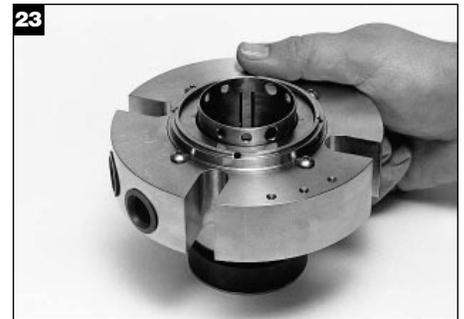
Limpie con un trapo limpio sin pelusa las caras de la rotativa y estacionaria externas. Deslice la brida sobre la camisa hasta que el reborde y el adaptador toquen fondo dentro del piloto de la brida.
