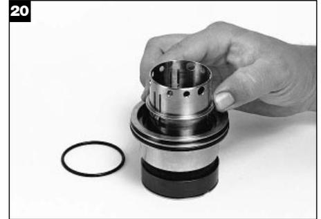
Deslice la arandela de respaldo sobre la camisa, presionando las orejas impulsoras de la rotativa hacia adentro, si es necesario, hasta que se asiente sobre el juego de orejas del medio en la camisa. Deslice el aro tórico del diámetro interior del collar hacia arriba contra la arandela de respaldo, presionando hacia adentro, otra vez, las orejas impulsoras, si es necesario.
