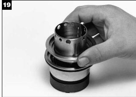
Deslice al adaptador sobre la camisa hasta que se guíe dentro del reborde y enganche sus espigas antirrotativas con las ranuras del impulsor de la estacionaria.
