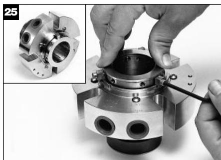
Presionando hacia abajo sobre la brida instale las grampas centradoras usando los tornillos de cabeza hueca para asegurarlas al anillo de fijación. Apriete con los dedos los tornillos de cabeza y luego, con la llave hexagonal, apriételes 1/8 de vuelta adicional. Asegúrese de que todas las grampas centradoras toquen fondo uniformemente sobre el retenedor.
