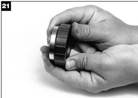
Coloque el aro tórico del diámetro externo del collar en el collar. Presione la rotativa externa sobre el collar hasta que toque fondo.
