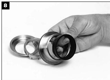
Deslice y saque el adaptador, el hombro, el impulsor de la estacionaria, de la camisa y separe todos los componentes. Saque los resortes del impulsor de la estacionaria y los dos aros tóricos del reborde.
