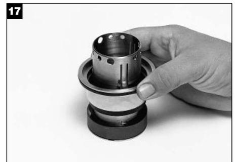
Limpie con un trapo limpio sin pelusa las caras de la rotativa y estacionaria internas. Coloque la camisa con el lado del anillo de fijación hacia arriba sobre una superficie plana. Deslice el conjunto estacionaria/reborde sobre la camisa hasta que la rotativa y la estacionaria entren en contacto.
