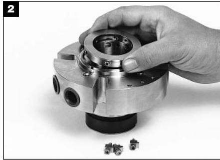
Coloque el sello, con el anillo de fijación hacia arriba, sobre una superficie plana. Quite las grampas centradoras. Presionando hacia abajo por el anillo de fijación, retroceda todos los tornillos prisioneros hasta que se desenganchen de la camisa. Levante y saque el anillo de fijación de la camisa y saque todos los tornillos.
