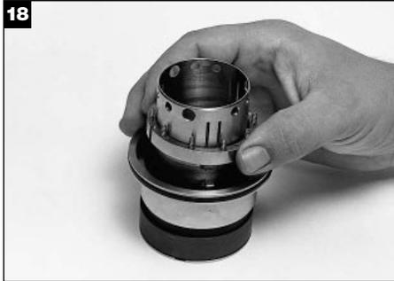
Deslice el impulsor de la estacionaria sobre la camisa hasta que sus lengüetas antirrotativas enganchen en las ranuras de la estacionaria.
